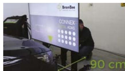
**4. INSERISCI LE MISURE RICHIESTE, LEGGENDOLE GRAZIE AI DUE METRI LASER. QUESTI SONO I PARAMETRI NECESSARI PER ESEGUIRE LA FUNZIONE KEYSTONE.**
